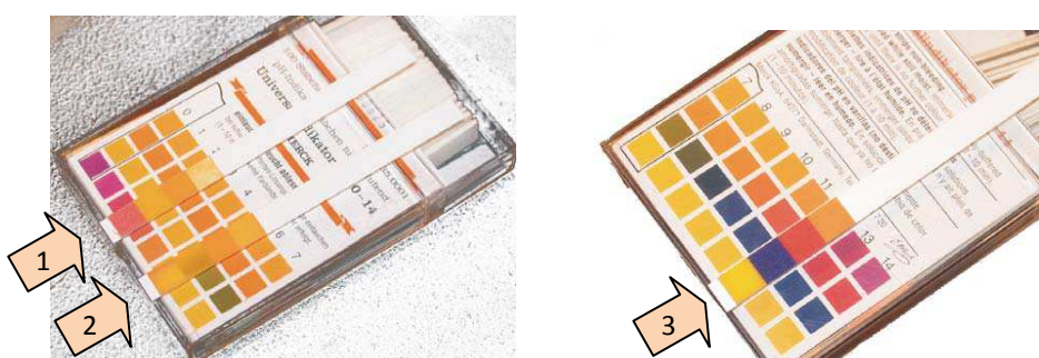
Fig. 2.- Determinación del pH de una solución utilizando tirillas indicadoras. Las tirillas se sumergen en la solución y se comparan con el patrón de coloración impreso en la caja para asignarles un pH. 1) coloración correspondiente a una solución con pH ácido cercano a 2 unidades de pH. 2) coloración correspondiente a una solución con pH levemente ácido. 3) coloración correspondiente a una solución con pH básico.
